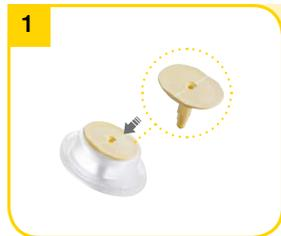
Вставьте соединительную деталь (вместе с O-образным кольцом) в отверстие на верхней стороне диафрагмы. Соединительная деталь и диафрагма являются деталями рукоятки молокоотсоса.
