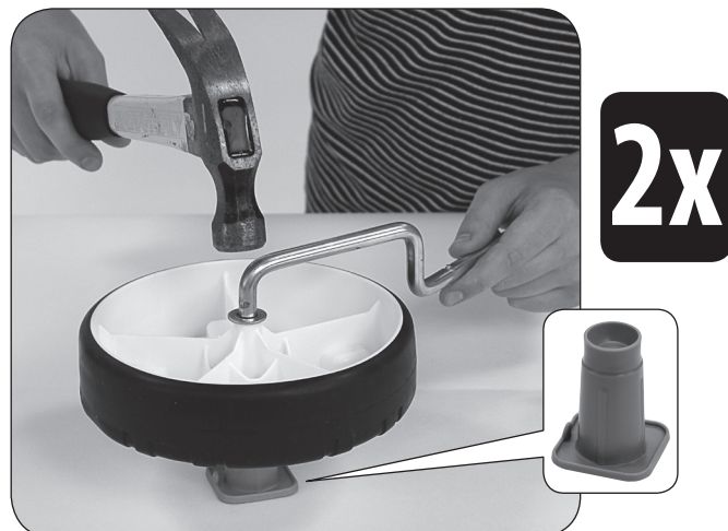
While holding the axle cap tool in place, turn entire wheel assembly over and rest it on the axle cap tool. Hammer axle onto axle cap. Repeat for RIGHT front axle. Tout en maintenant l'outil pour chapeau d'essieu en place, retournez la totalité de l'assemblage de roue et faites-le reposer sur l'outil pour chapeau d'essieu (comme indiqué). Martelez l'essieu pour l'insérer dans le chapeau d'essieu. Répétez ces étapes pour l'essieu avant DROIT. Mientras sostiene en su lugar el dispositivo para remate del eje, dé vuelta el conjunto de la rueda y apóyelo en dicho dispositivo (tal y como se muestra). Martille el eje en el remate. Repita para el eje delantero DERECHO
